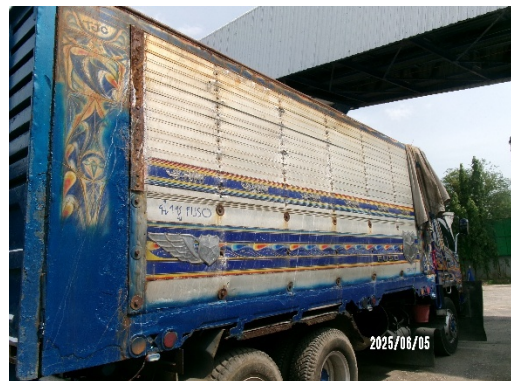
รูปที่ 3-24 รถบรรทุกมีแผงกูด้านข้าง
